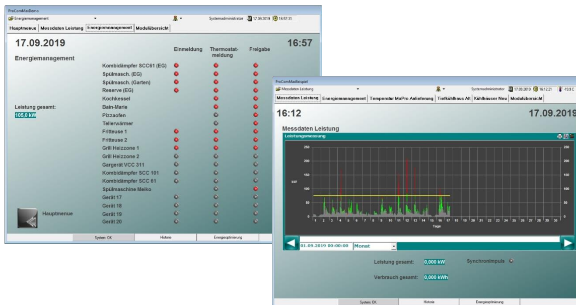
Abb. 3 Status der Geräte und Messkurvendarstellung
